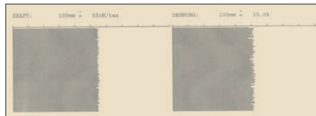
Viscose SULKY en test de force-allongement: bonne solidité à la rupture totale
